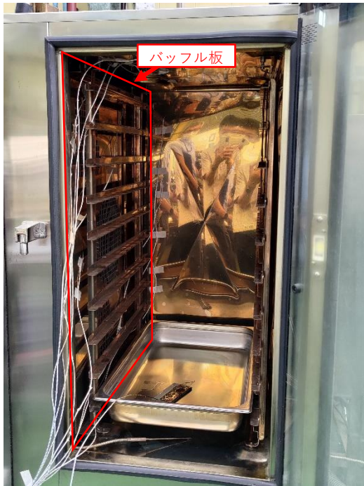
写真4 庫内外観（バッフル板及び棚を設置した状態）
